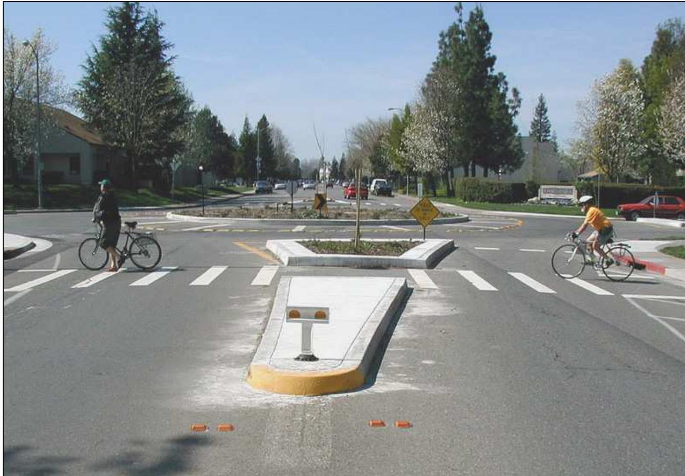
Le **isole spartitraffico** sono elementi molto importanti per la sicurezza delle rotatorie
