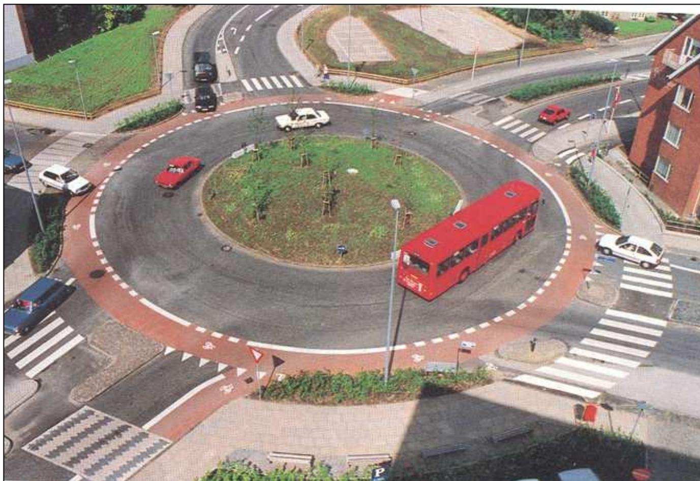
*Un esempio di rotatoria potenzialmente pericolosa per i ciclisti, in quanto la corsia ad essi destinata è ricavata all'interno della corona giratoria e costituisce di fatto un ampliamento dell'anello veicolare*
