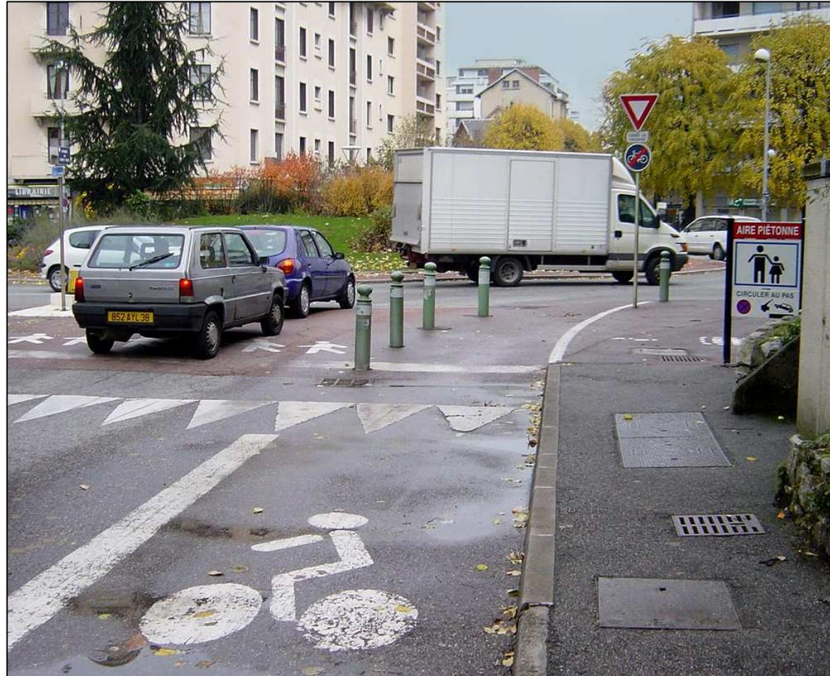
*Una rotatoria a Chambéry in cui la pista ciclabile termina prima della rotatoria e il ciclista può scegliere se proseguire sull'anello veicolare o immettersi nel percorso pedonale, che in quel punto si trova allo stesso livello*
